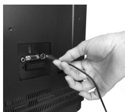
Zapojte koniec koaxiálneho kábla do vstupného otvoru RF televízora.
