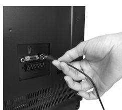
Podłączyć kabel koncentryczny do wejścia RF w telewizorze.
