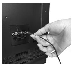
Zapojte konec koaxiálního kabelu do vstupní zdířky RF televizoru.
