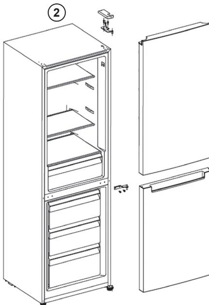
3. Wykręcić trzy śruby, które trzymają dolny zawias pod prawą stroną lodówki. Zdjąć dolny zawias i nastawną nóżkę pod dolny zawiasem pod prawą stroną lodówki. Jednocześnie kluczem wykręcić śruby, które trzymają oś zawiasu; następnie zdjąć nastawną nóżkę na spodniej lewej stronie pod lewą stroną lodówki.
