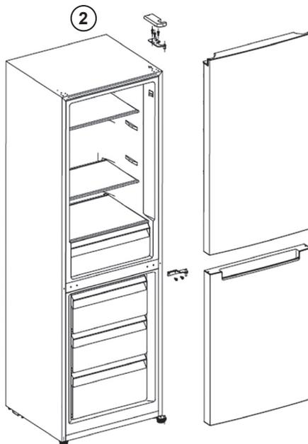
3. Odstráňte tri skrutky, ktoré držia spodný záves pod pravou stranou skrine. Odstráňte spodný záves a nastaviteľnú nožičku pod spodným závesom pod pravou stranou skrine. Súčasne kľúčom vyskrutkujte skrutky, ktoré držia osu závesu; potom zložte staviteľnú nožičku na spodnej ľavej strane pod ľavou stranou skrine.
