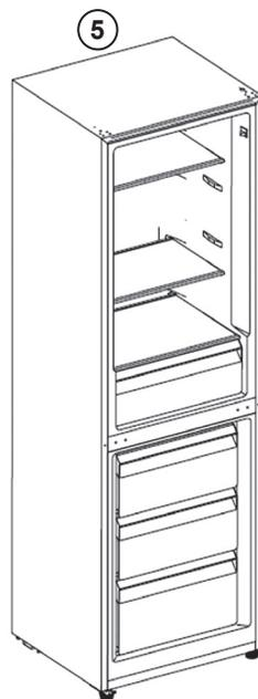
5. Wziąć drzwi zamrażarki, upewnić się, że oś dolnego zawiasu i otwór na oś na spodniej stronie lodówki dobrze trzymają i prawidłowo pasują. Teraz drzwi zamrażarki są w zasadzie umocowane; następnie z pomocą dwóch śrub umocować zawias środkowy na lewą stronę lodówki; następnie dokręcić zawias środkowy (według rysunku 6).
