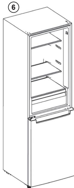
6. Vezměte dvířka chladničky, ujistěte se, že osa spodního závěsu a otvor na osu na spodní levé straně spotřebiče dobře drží a správně zapadají; nyní jsou dvířka chladničky v podstatě připevněná. Poté použijte šrouby, které jste vyjmuli v prvním kroku, k připevnění horního závěsu na levou stranu skříně; nasadte kryt horního závěsu a přišroubujte.
