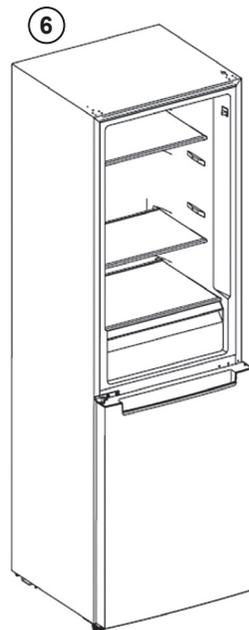
6. Vezmite dvierka chladničky, uistite sa, že os spodného závesu a otvor na os na spodnej ľavej strane spotrebiča dobre drží a správne zapadajú; teraz sú dvierka chladničky v podstate pripevnená. Potom použijete skrutky, ktoré ste vybrali v prvom kroku, na pripevnenie horného závesu na ľavú stranu skrine; nasadíte kryt horného závesu a priskrutkujete.
