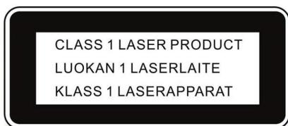
Urządzenie zawiera część laserową (Klasa 1 - lasery które są bezpieczne w racjonalnych warunkach pracy). Etykieta THE CLASS 1 LASER PRODUCT znajduje się z tyłu obudowy.
